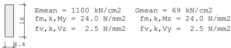
Spannungen mit FLBemHo901 gerechnet. (Version 9.0.4.2)
