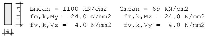
Bei Kombinationen mit Wind als kürzester Einwirkung wird für  $k_{mod}$  das Mittel aus kurz und sehr kurz verwendet (Tab. NA1 b).
